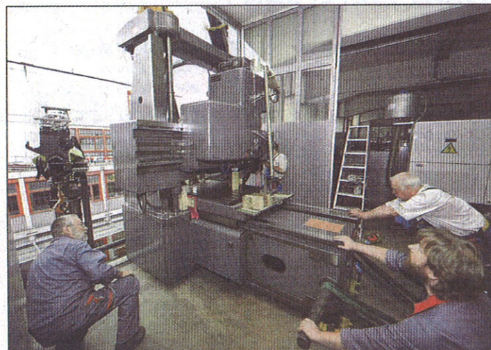
Vorher: Sorgfältig wird die Maschine angeschoben und zentimeterweise gegen die Öffnung im zweiten Obergeschoss bewegt.
